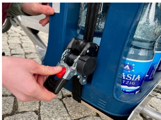
5. Spannband mit Ratsche festzurren, Sitz kontrollieren
