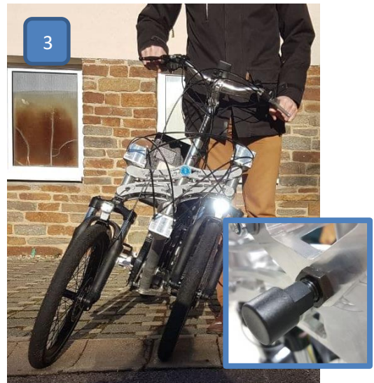
Neigungsfunktion ist aktiviert, Knopf ist ausgefahren
