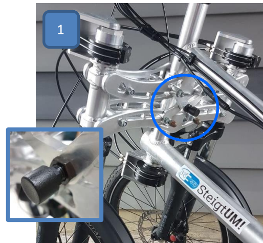
Neigungsfunktion deaktiviert, Knopf ist eingefahren
