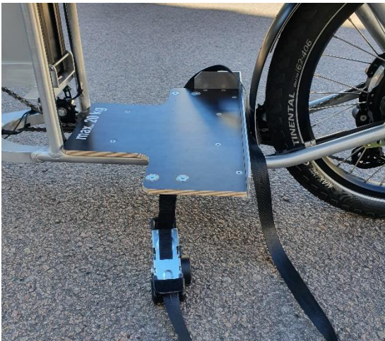
4. Spannband über Ladung legen und vorspannen
