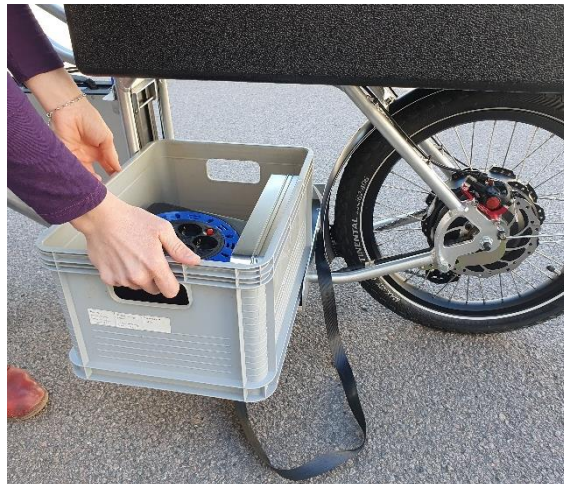
5. Spannband mit Ratsche festzurren, Sitz kontrollieren
